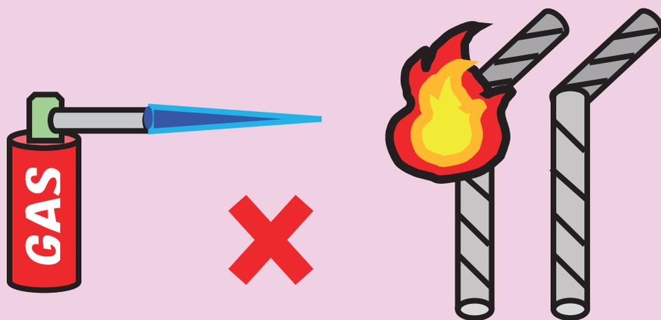
また、水道管等の経路を確認せずに、自分で電気解凍機を使用すると、**ステンレス製のフレキシブル配管等が赤熱し、壁体内の断熱材に着火することがありますので、注意が必要です。**
