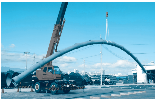
ダクタイトル鉄管の耐震性能のクレーン吊り上げ実験 提供：一般社団法人 日本ダクタイトル鉄管協会
