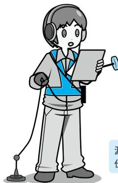
漏水探知機を使い、路面や水道管に伝わる音によって漏水を探します。
