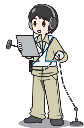
地面に伝わる音で漏水を探します
