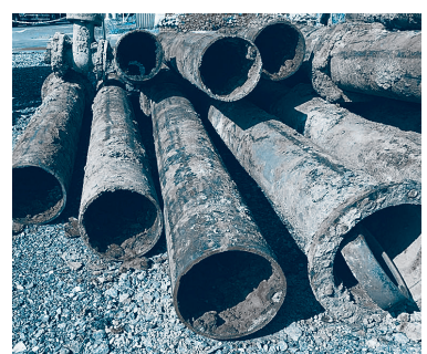
更新した古い水道管 (昭和 44 年布設)
